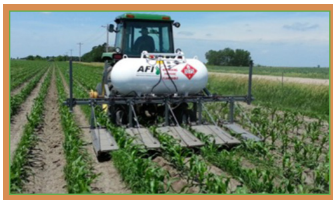
Fot. 17. Międzyrzędowy pielnik płomieniowy
