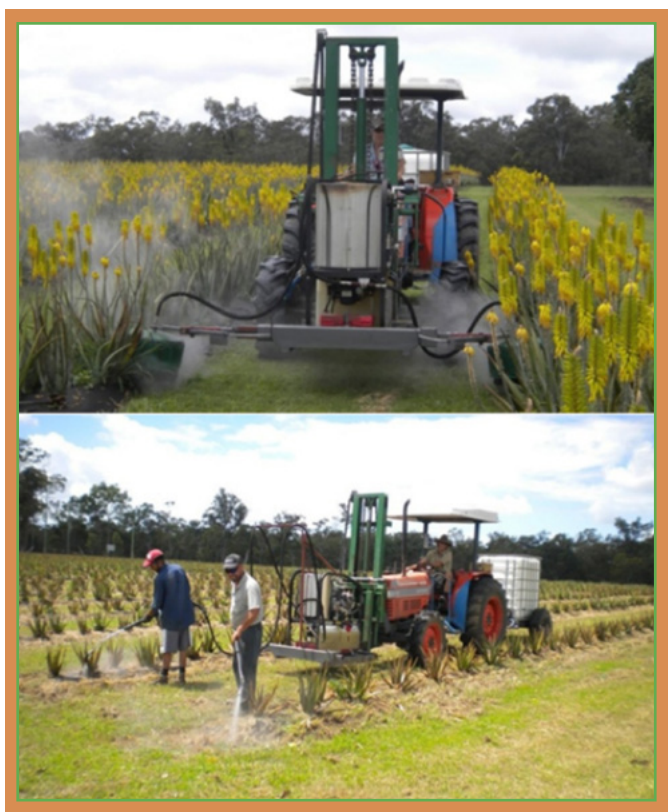
Fot. 16. Ograniczanie zachwaszczenia przy użyciu pary wodnej
