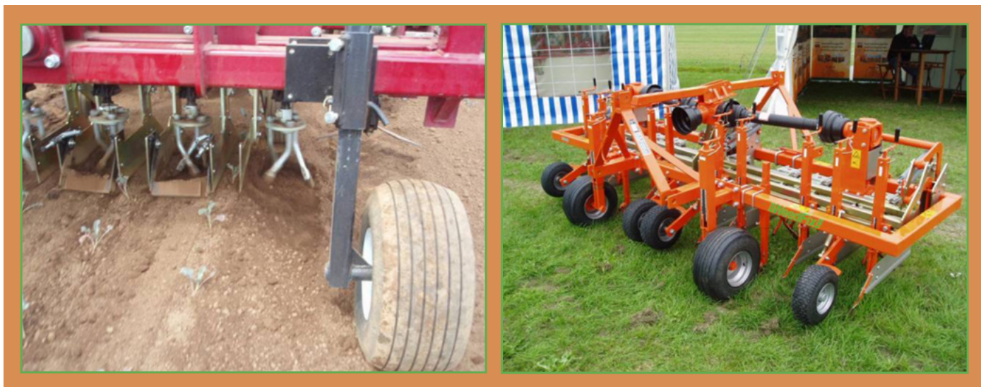
Fot. 11. Pielnik zębowy o osi pionowej
