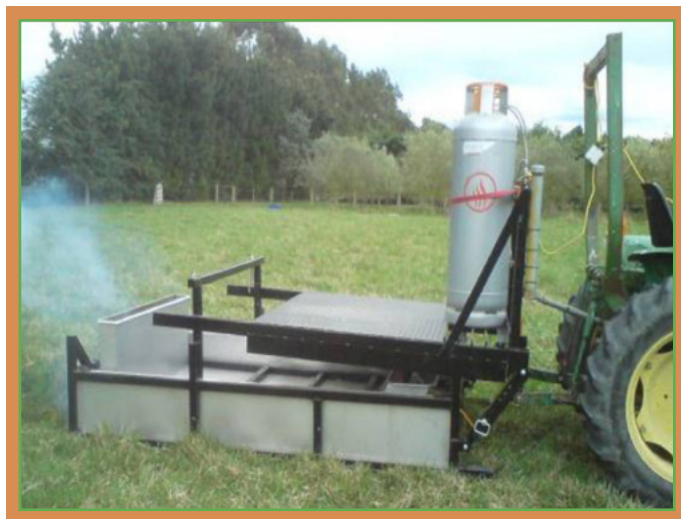
Fot. 14. Pielnik płomieniowy używany w technice przedsiewnego ograniczania chwastów
