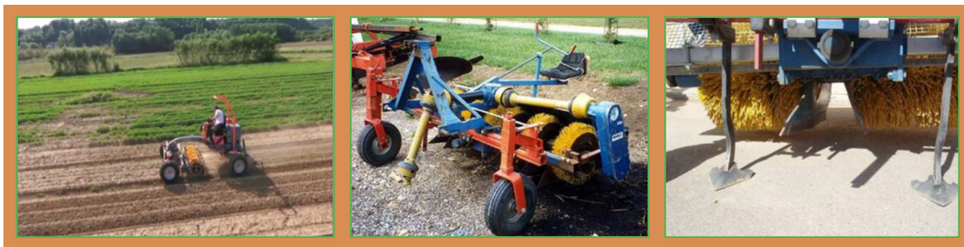
Fot. 9. Pielnik szczotkowy o osi poziomej
