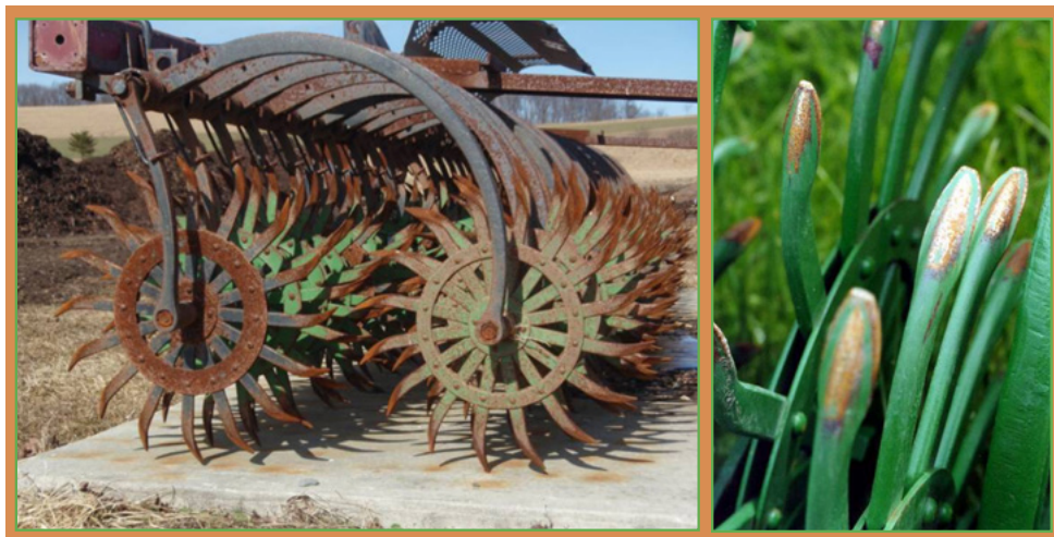
Fot. 3. Brona chwastownik obrotowa prosta
