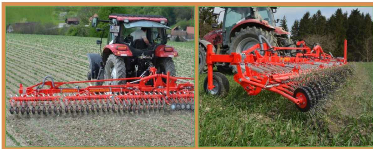
Fot. 4. Brona obrotowa skośna (Aerostar Rotation) (zdjęcia Einböck GmbH & CoKG)
