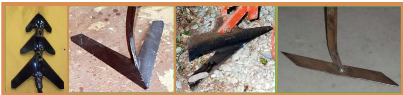
Fot. 7. Ostrza pielników (od lewej do prawej); gęsia stópka, ostrze typu A, ostrze typu L, ostrze typu T
