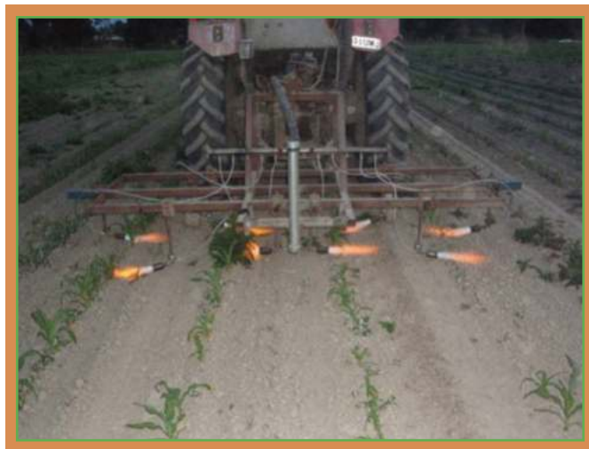
Fot. 15. Selektywny pielnik płomieniowy do zwalczania chwastów w rzędzie w uprawie kukurydzy cukrowej
